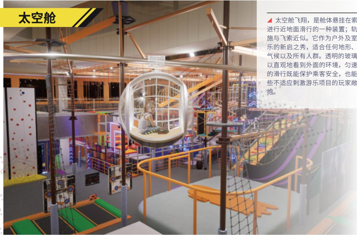
▲ 太空舱飞翔，是舱体悬挂在索道上进行近地面滑行的一种装置；轨道设施与飞索近似。它作为户外及室内游乐的新启之秀，适合任何地形、任何气候以及所有人群。透明的玻璃罩可以直观地看到外面的环境，匀速平稳的滑行既能保护乘客安全，也能对那些不适应刺激游乐项目的玩家敞开怀抱。
